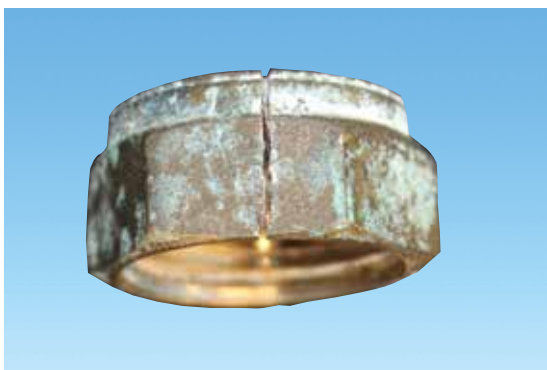
Figur 3.16 Eksempel på spændingskorrosion i omløber
