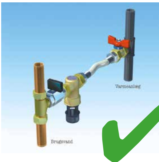
Figur 4.4 (Ulovlig) sammen- kobling af brugs- vandsanlæg og varmeanlæg
