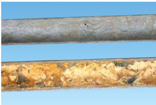
Figur 3.14 Typiske korrosionsskader i varmforzinkede stålrør i blødt vand, hvor varmforzinket stål har vanskeligt ved at opbygge gode beskyttende belægninger
