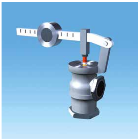
Figur 5.1 Sikkerhedsventil med vægtstang - som stadig kan opleves på ældre anlæg
